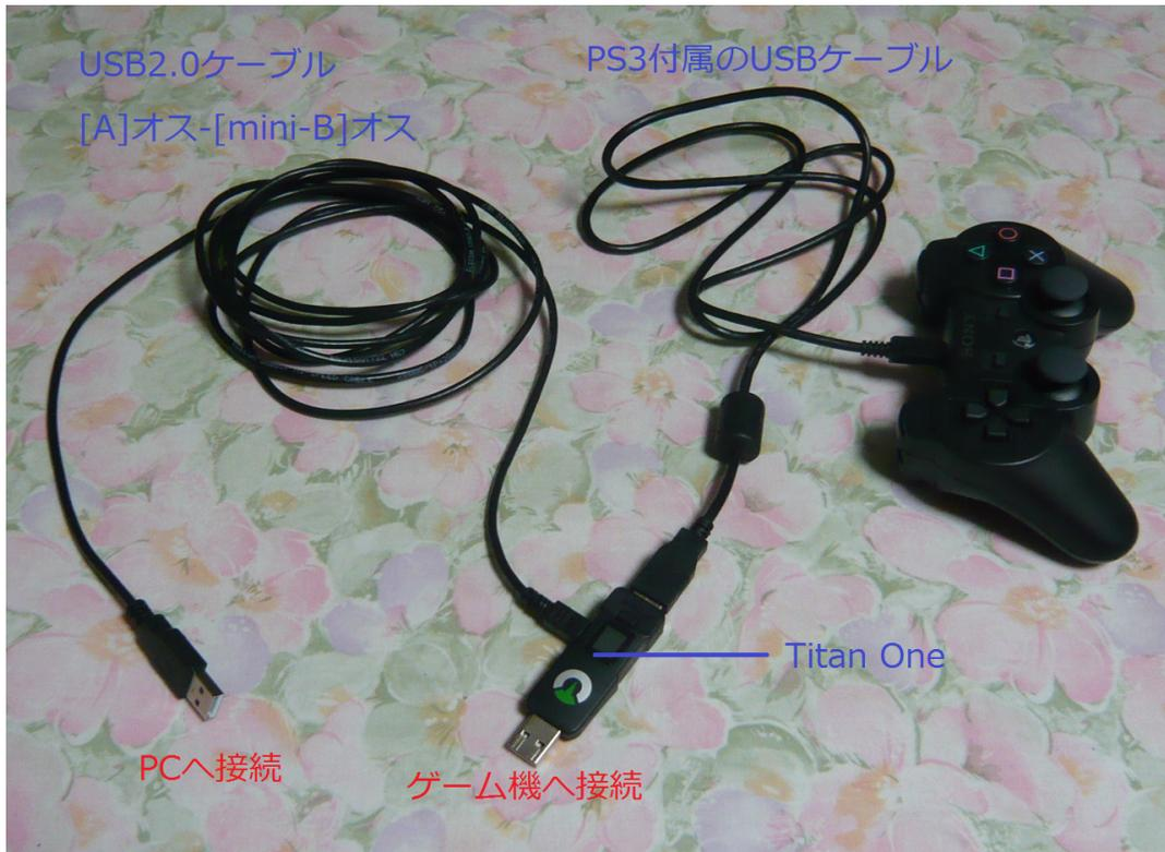
のように接続します。USB2.0 ケーブルと書かれて映っているのは、市販の PS3 専用ケーブルと同じ物です。この画像を詳しく説明すると、Titan One の銀色の端子の反対側の凹んだ端子に USB ケーブルを介して PS3 のコントローラを接続しています。残った横の端子には USB ケーブルをつないであります。それを介して PC に接続します。Titan One の銀色の端子は PS3 本体のコントローラを差し込むところ(1P 用)に入れます。
